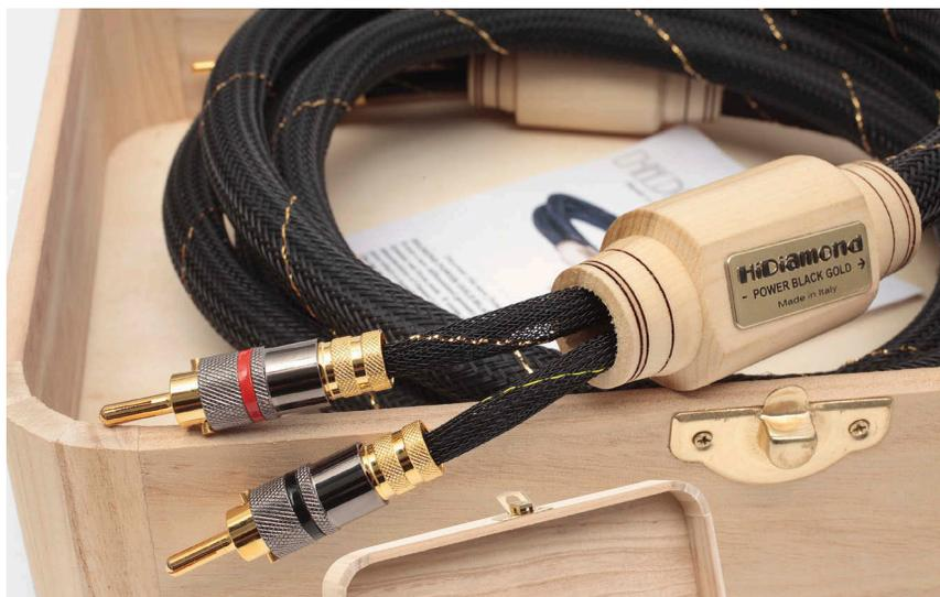
Сейчас выпускается в новом оформлении, но с той же структурой и геометрией. Малое погонное сопротивление и подавление скин-эффекта обеспечивается 12 проводниками 4VRC, состоящими из 48 жил 0,22 мм, что даёт общее сечение по меди порядка 2 кв. мм. Несмотря на солидный диаметр (27 мм), кабель довольно гибкий. Терминалы — цанговые «бананы», на обоих концах имеются заделочные деревянные бруски с закруглёнными рёбрами. Пара упакована
